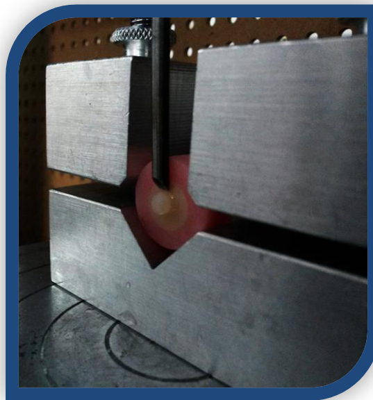
Figura 19 Muestras fijadas para la prueba de fuerza de adhesión.
