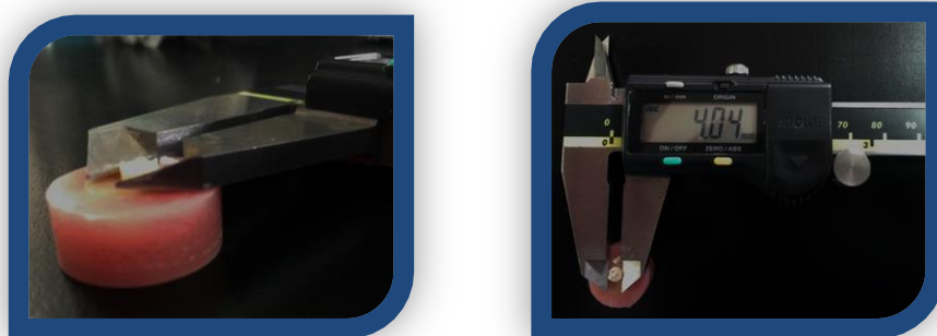
Figura 18. Se obtiene el diámetro promedio del botón y se obtiene el área mediante la fórmula A = \pi r^2
