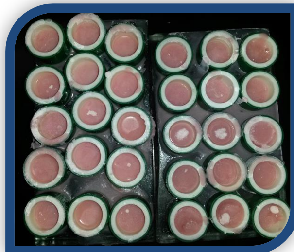
Figura 7. Muestras cilíndricas previo a la polimerización de las mismas.
