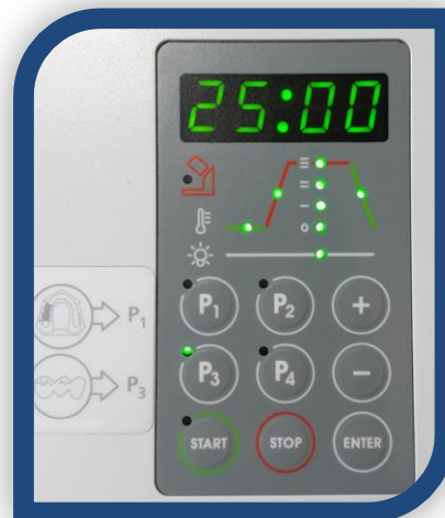
Figura 4 Se colocan las muestras y selecciona el programa 3 del Lumamat 100 para un tiempo de 25 minutos.
