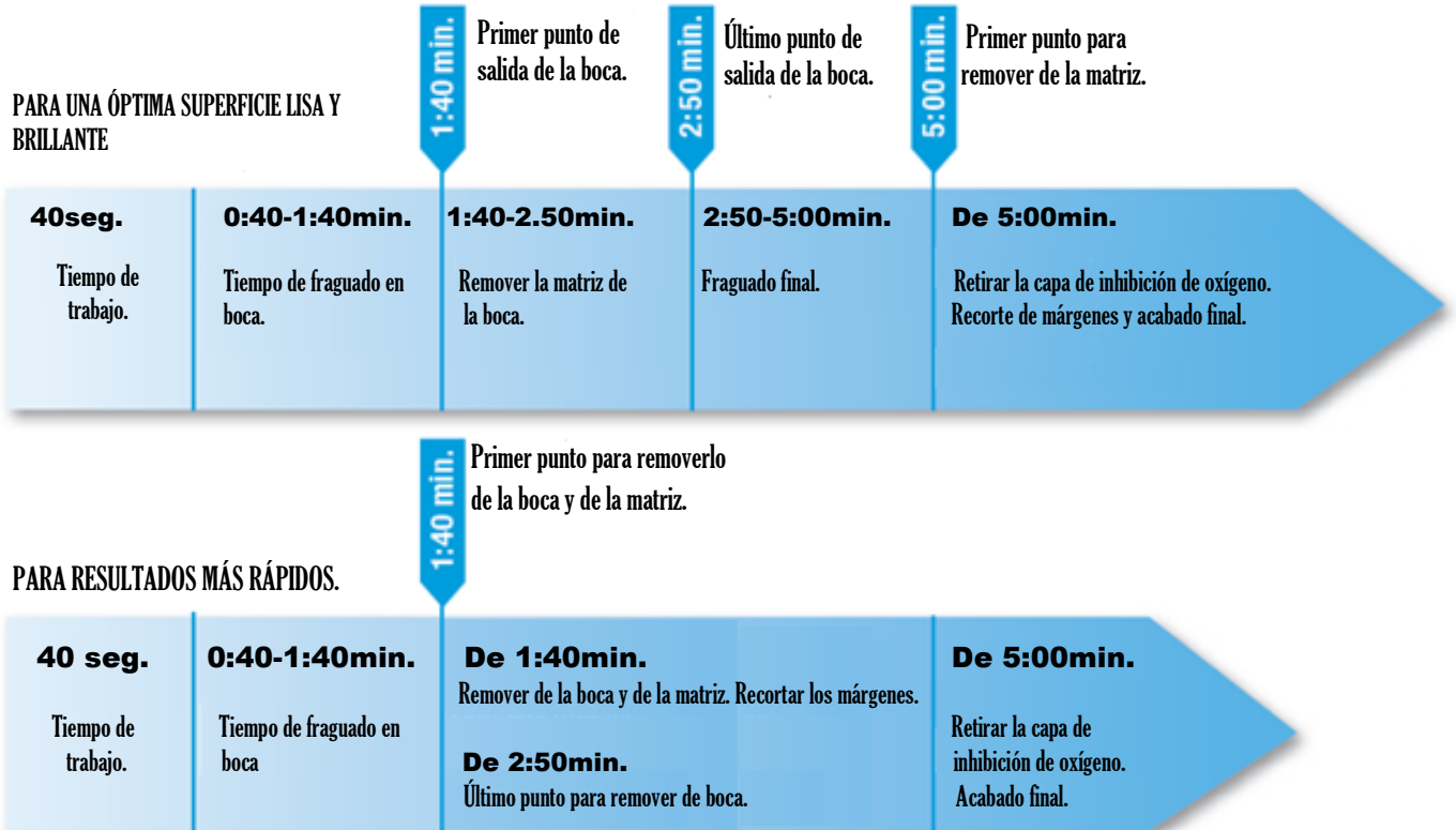
Fig.67. Dos opciones de tiempo de trabajo con resina bis-acrítica Protemp™Plus 3M ESPE 22 .
