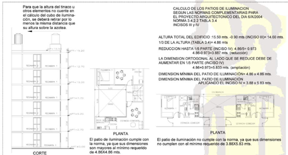
Ejemplo de aplicación para el cálculo de patios de iluminación
