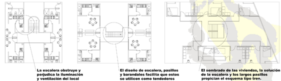
Ejemplos de diseño de escaleras que se deben evitar
