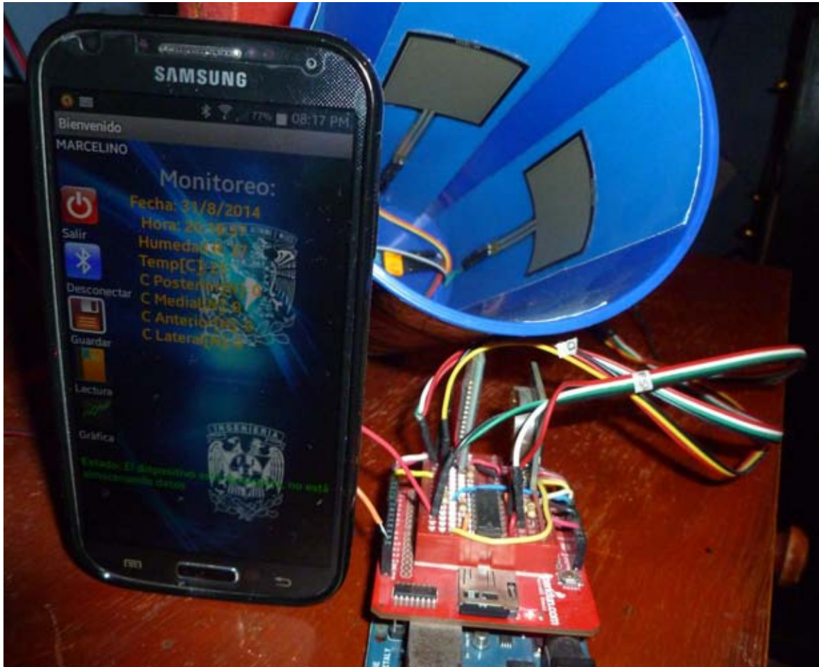
Figura 40. Aplicación instalada en el móvil, junto con los sensores instalados en el modelo funcional y los componentes montados sobre la placa Arduino Uno
