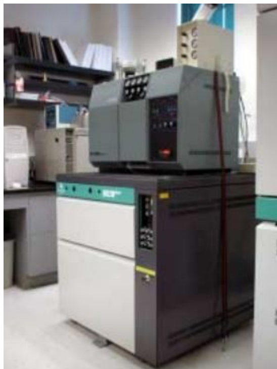
Fig. 1 Analizador elemental Carlo Erba™ NA1500 Series 2 acoplado a un Espectrómetro de Masas Finnigan™ Delta Plus.
