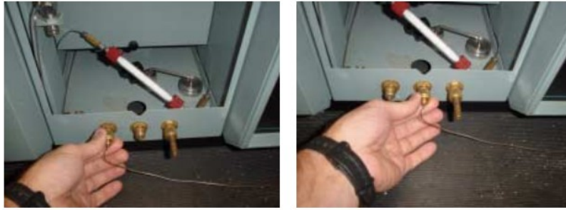
Fig 2. Cambio de la línea de acero inoxidable del analizador elemental de la posición Vent-M (izquierda) a la posición Vent-R (derecha).
