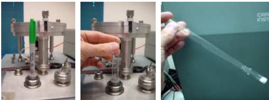
Fig. 3. Desmontaje del carrusel de la columna del reactor de combustión. Paso 1: aflojar la válvula superior (izquierda), paso 2 (en medio): desenroscar la conexión entre el carrusel y el reactor, paso 3 (derecha): desenroscar y desconectar la línea de helio. Posteriormente mover el carrusel.
