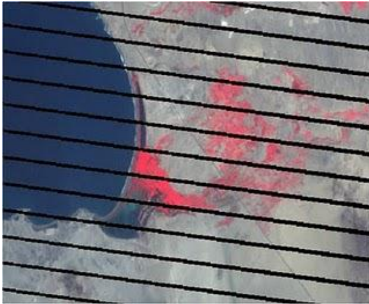
Figura 8 Ejemplo del efecto "gap" en las imágenes del sensor ETM+
