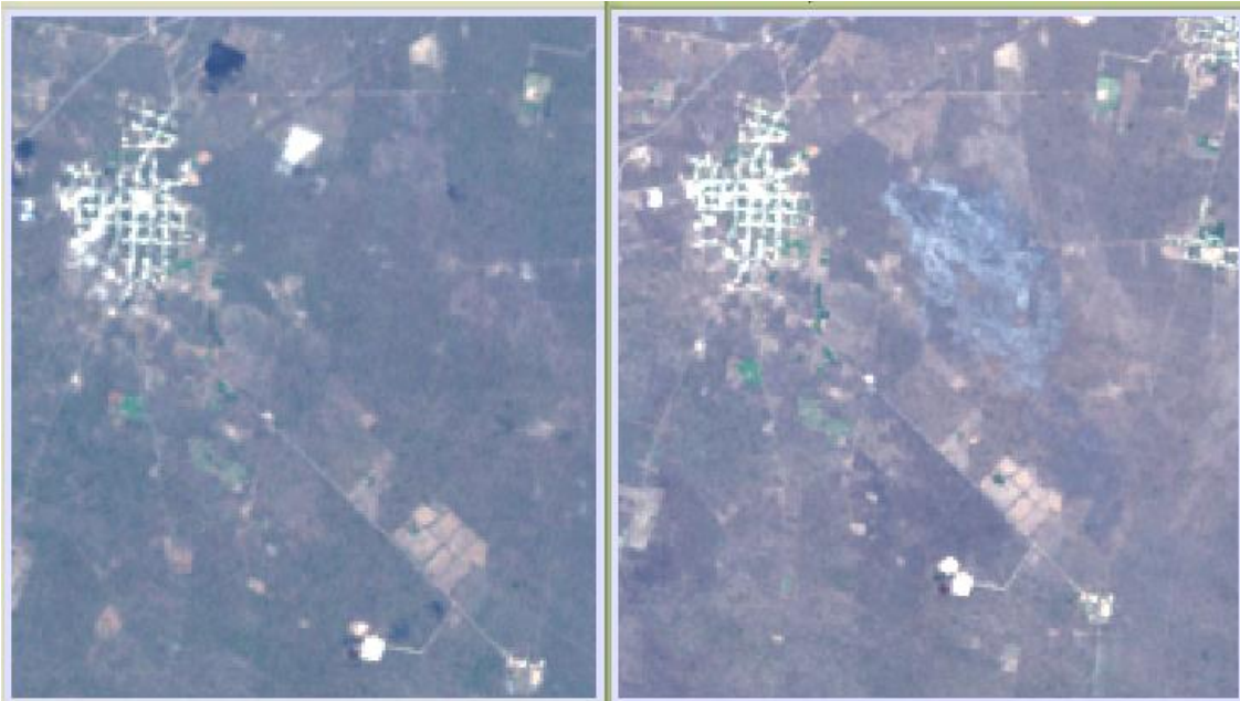
Figura 15 Comparación de compuestos de color RGB 321 de imágenes Landsat de febrero 2009 (izquierda) y mayo 2009 (derecha)
