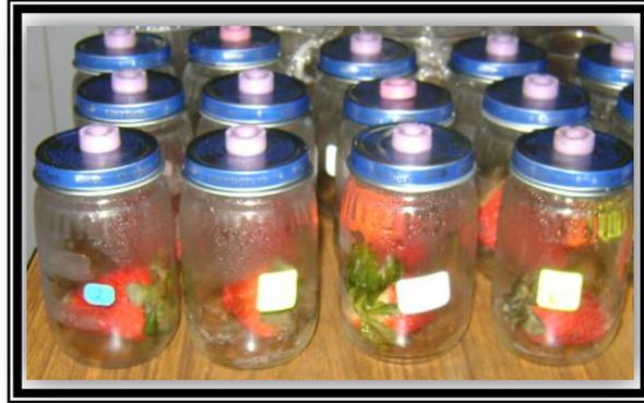
Figura 13. Frascos con fresas para medición de oxígeno
