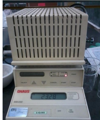
Fig.3.4.2.7 Equipo para la determinación de la humedad (balanza de humedad)
