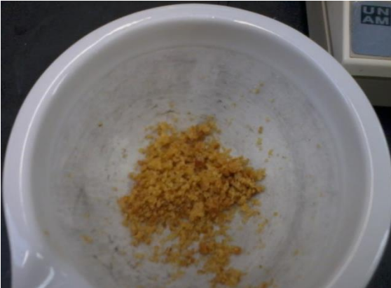
Fig.3.4.2.6 Muestra triturada, para realizar la prueba de humedad
