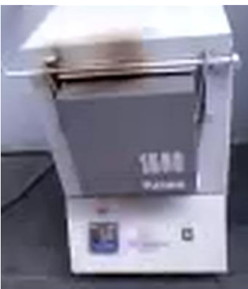
Fig. 3.4.2.11 Mufla para calcinar
