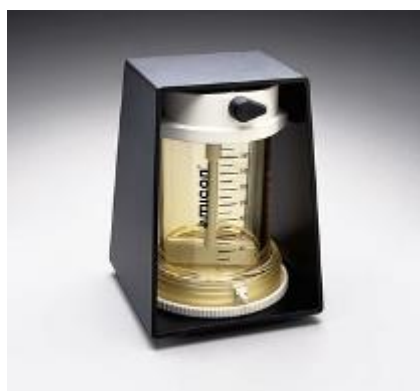
Fig. 11. Sistema de ultraconcentración Amicón. En él se coloca una membrana de cierto tamaño de poro, se introduce la muestra y se aplica presión para desplazar el líquido.
