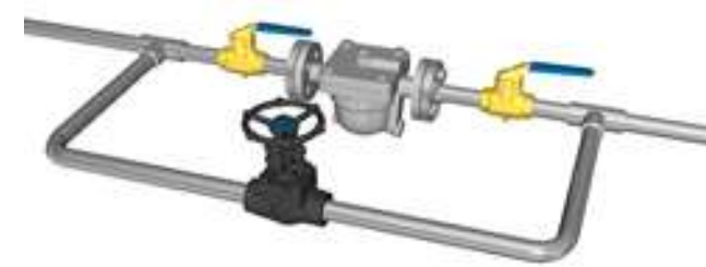
Fig. H.4 Tubería con Bypass
