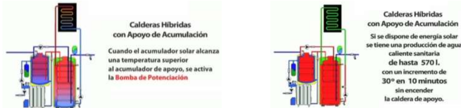
Fig. H.6 Esquema de funcionamiento de Caldera Solar Híbrida
