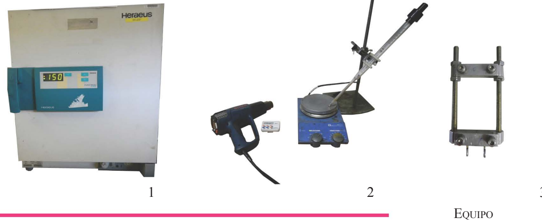
Figura 37. Equipo empleado en la Programación de Memoria de Forma.
