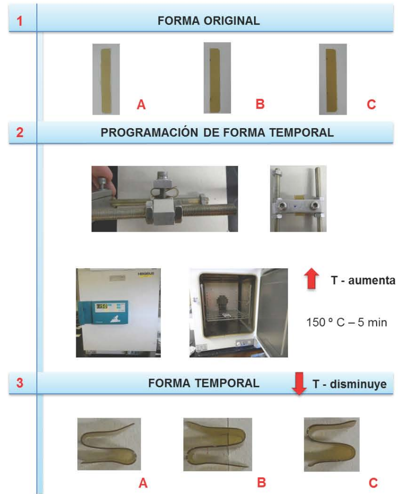
Figura 62. Programación de la forma temporal de tiras de XNBR
