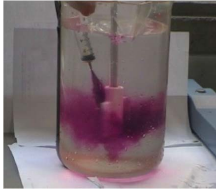
Figura C.6. Fotografía obtenida en el Laboratorio de Fluidos de la Facultad de Ciencias Físicas y Matemáticas de la Universidad de Chile de un tipo de agitador tipo ancla.
