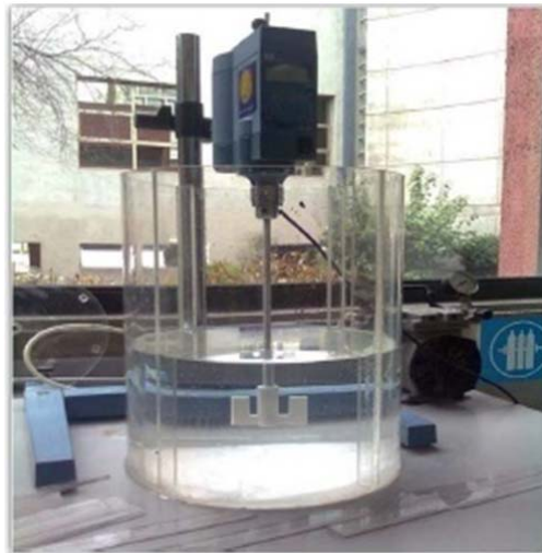
Figura C.5. Fotografía obtenida en el Laboratorio de Fluidos de la Facultad de Ciencias Físicas y Matemáticas de la Universidad de Chile de un tipo de agitador tipo ancla.
