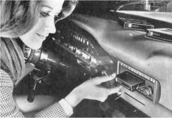
Figura 4-198 Imagen de un reproductor de cartuchos de ocho pistas instalado en un automóvil
