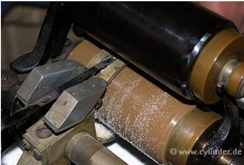
Figura 2-7 Imagen de un pantógrafo para duplicar cilindros.
