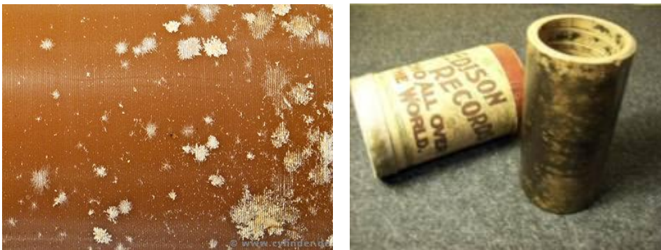
Figura 2-10 Imagen de cilindros de cera café, a la izquierda se puede observar como el deterioro por hongos forma lo que llaman u paisaje lunar, a la derecha se observa un cilindro afectado por moho con manchas verdosas.
