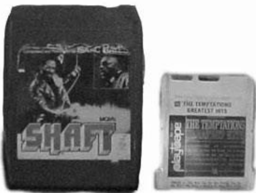
Figura 4-21 En esta imagen se hace una comparación de los tamaños del cartucho de ocho tracks que se muestra a la izquierda y el playtape a la derecha.
