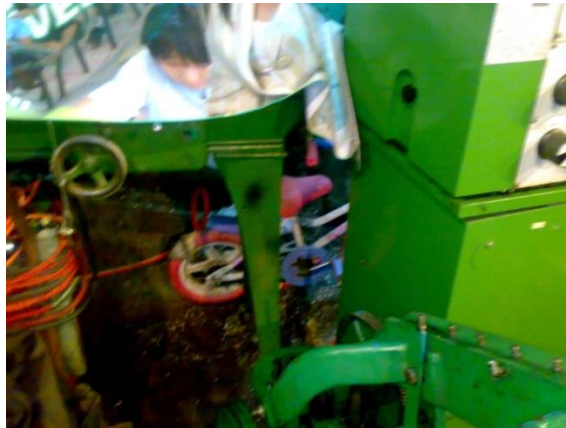
Figura 13-Falta de orden y limpieza torno
