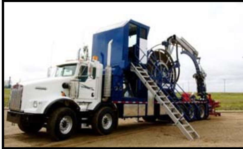
Figura 3. 11. Unidad de Servicio con TF, equipada con equipo de registro de pozos.
