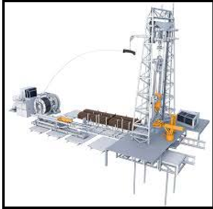
Figura 3. 6. Unidad de Perforación con Tubería Flexible.
