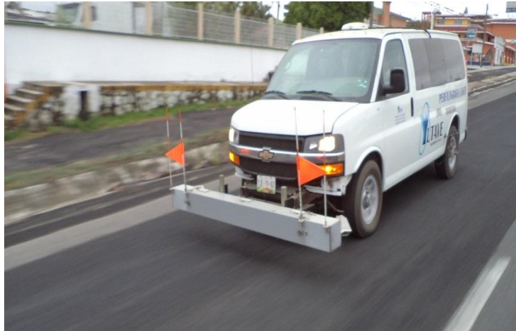
Figura. 3.6. Perfilómetro láser en operación (Fuente: Yutave Ingeniería S.A de C.V, 2013).
