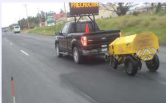
Se observa la obtención de índice de fricción con el equipo DFT
