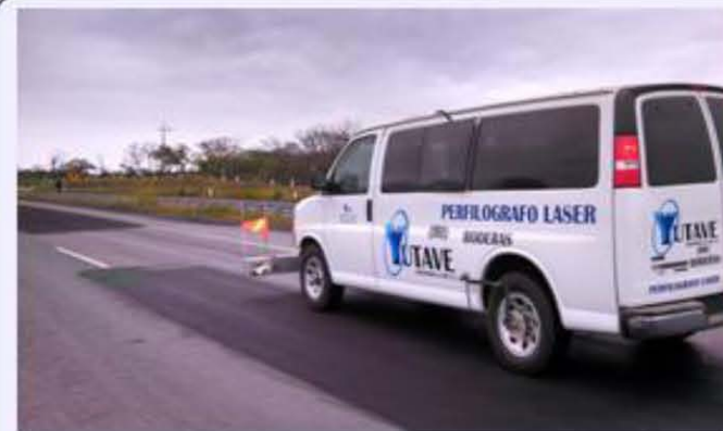
Se observa el levantamiento del IRI mediante Perfilómetro
