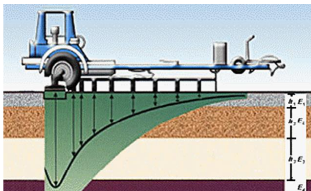
Figura 3.18.- Cuenca de deflexiones típica de un pavimento flexible (Fuente: Dynatest).
