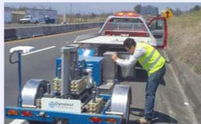
Se observa la programación del equipo FWD
