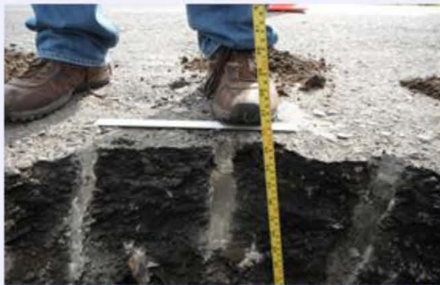
Se observa la medición de los espesores de las capas que conforman la estructura del pavimento
