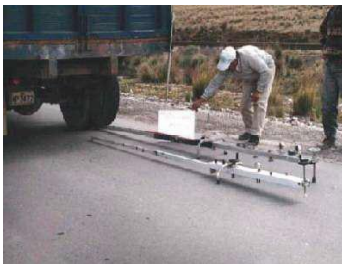
Figura 3.14.- Medición de deflexiones con Viga Benkelman (Fuente: Camineros.com, 2008).
