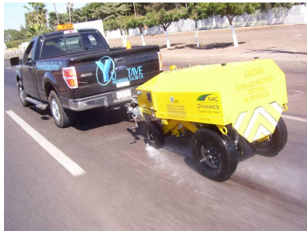
Figura. 3.11 Dynamic Friction Tester (DFT) en prueba de fricción dinámica (Fuente: Yutave Ingeniería S.A de C.V, 2009).
