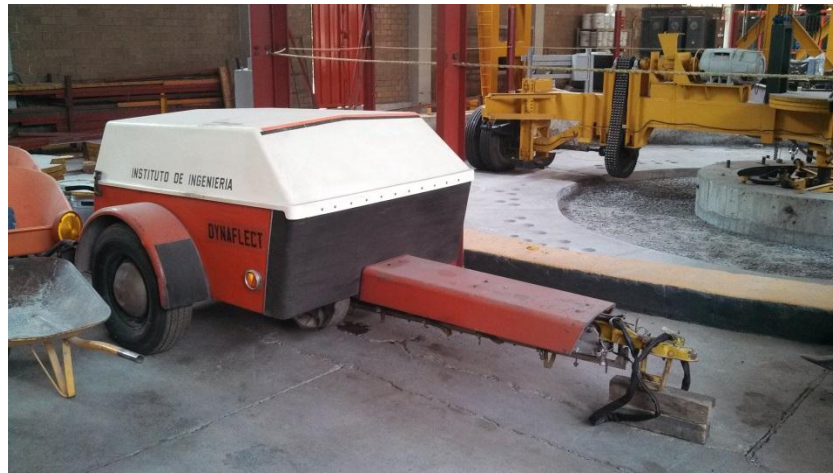
Figura 3.15.- Dynaflect en el laboratorio de Vías Terrestres (Fuente: Instituto de Ingeniería, UNAM, 2014).
