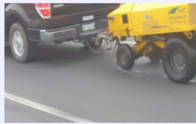
Se observa la obtención de índice de fricción con el equipo DFT
