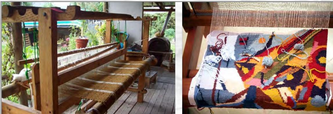
Figura 9. Fotografías de telares de Pedal.
