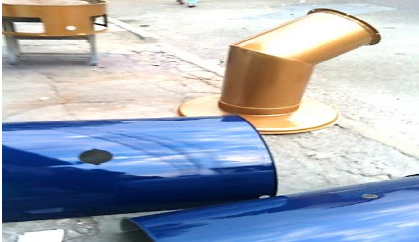
Figura 28. Aplicación de pintura en las tolvas principales.
