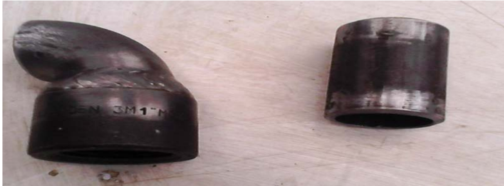
Figura 16. Codo y tubo para la salida de vapor.
