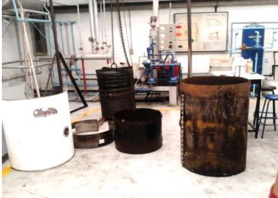
Figura 14. Unidad generadora desarmada en su totalidad.
