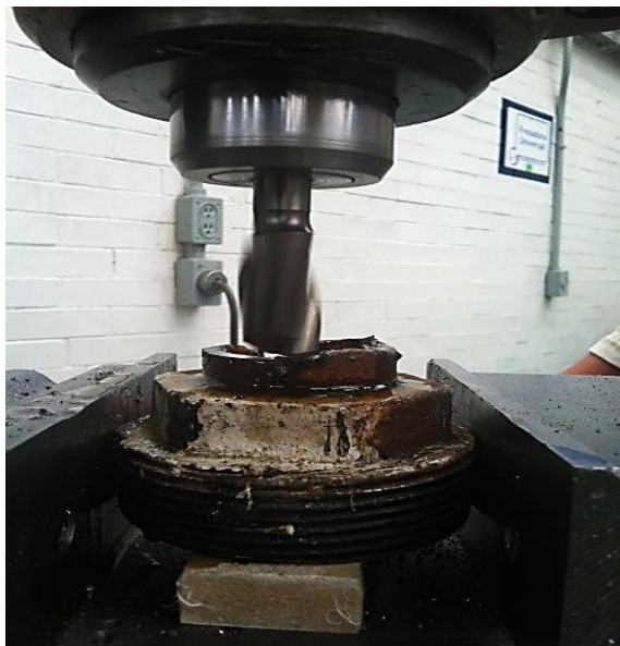
Figura 34. Maquinado del tapón para tubería.
