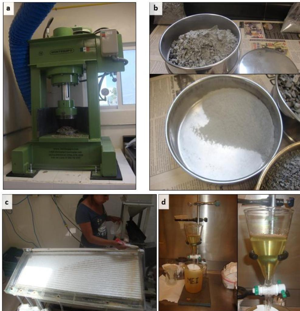
Figura 2.3. Preparación de muestras para la separación de los circones de areniscas fechadas en este estudio. (a) Trituración de la muestra. (b) Tamizado y obtención de la fracción menor a 500 micras. (c) Separación de circones y minerales de mayor densidad utilizando la mesa vibratoria Wilfley. (d) Separación de minerales pesados (incluidos circones) con líquidos pesados (e.g., yoduro de metileno).
