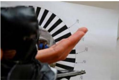
Se muestra una posición de reposo de la mano, donde se muestra una inclinación de 25 [°] con respecto a la posición inicial planteada en la articulación metacarpofalángica (conecta al metacarpo con la falange proximal).
