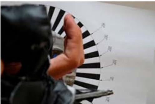
Se muestra a la mano para realizar el movimiento que permite un agarre cilíndrico, la desviación con respecto al punto anterior varía aproximadamente 10 [°], se puede apreciar que es la articulación interfalángica proximal la que realiza el mayor desplazamiento.
