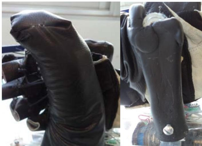
Figura 9.9 Joystick recubierto con la imitación de piel y la polea contenida en su interior.
