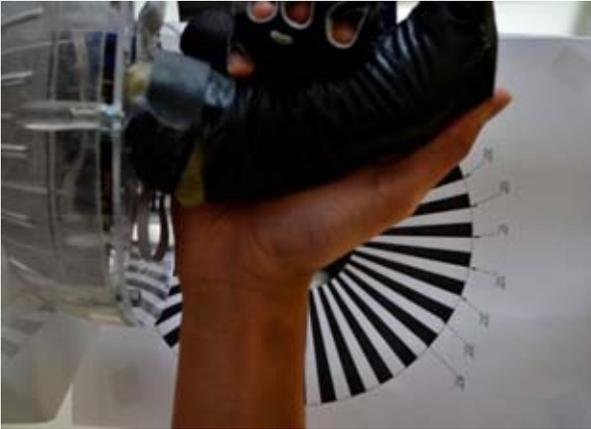
En la imagen se muestra la posición inicial de la prueba de aducción y abducción. La marca está basada en la inclinación que tiene la mano con punto de referencia en el cruce de la muñeca.
