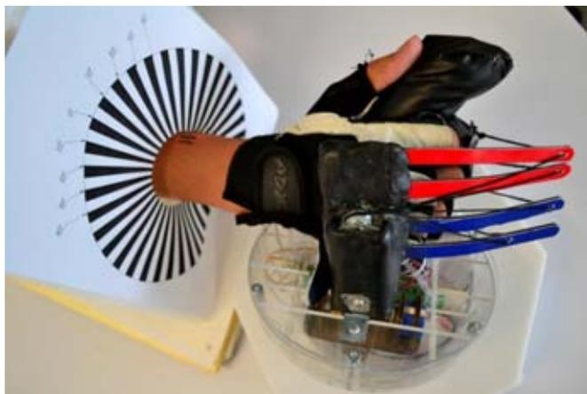
Se puede apreciar el resultado del movimiento obtenido con la pronación, con 40 [°] de desplazamiento angular.
