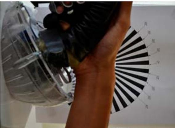
En la imagen se puede observar la variación en la inclinación de la desviación radial, de aproximadamente 25 [°] de desplazamiento angular.
