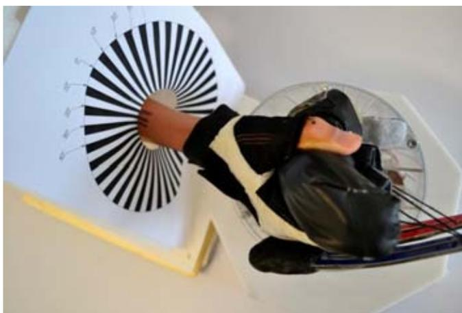
Se puede apreciar el movimiento obtenido con la supinación, con 25 [°] de desplazamiento angular.
