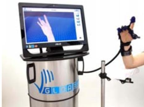
Figura 3.17 Gloreha Glove® con su visualización 3D en una pantalla de computadora. [63]
