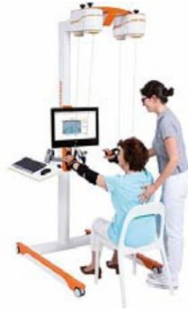
Figura 3.12 Prueba con los brazos del sistema Diego® de Tyromotion. [58]
