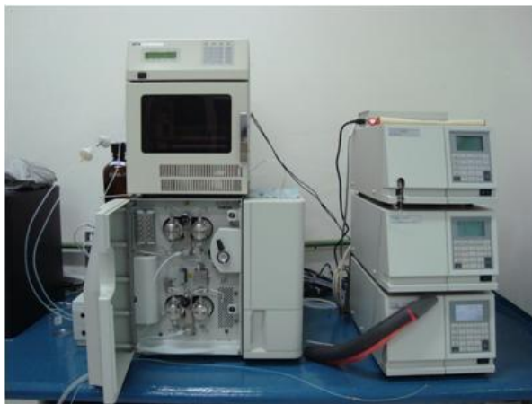
Figura 2. Equipo de HPLC utilizado en el análisis de aminoácidos de los insumos que conformaron las dietas para los reproductores de O. maya y luego en las muestras de vitelo de los huevos producidos por las hembras alimentadas con las diferentes dietas experimentales.
