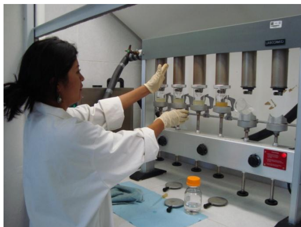
Figura 1. Instrumento utilizado para la extracción de lípidos totales en las dietas experimentales
