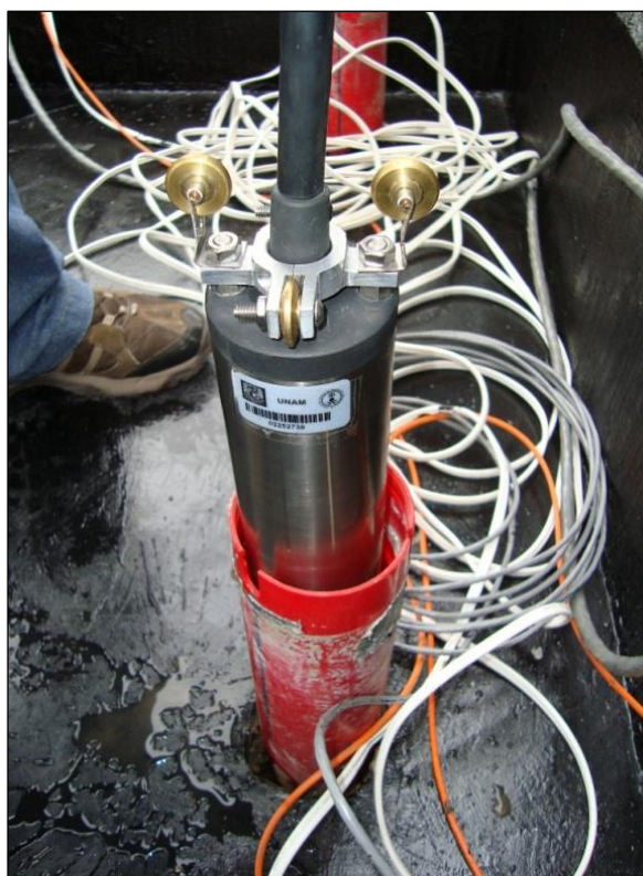
Figura 2.9 Colocación de sensores de pozo (ref. 48)
