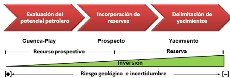
Figura 2.2 Principales etapas del proceso exploratorio y visualización de los recursos por etapa. Fuente: José A. Escalera 2010
