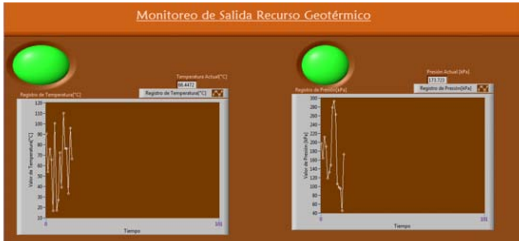
Figura 3.25 Gráficas de Temperatura y Presión de Salida Recurso Geotérmico
