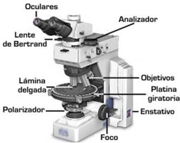
Fig. 2.3. Esquema del microscopio petrográfico (SGM, 2013).
