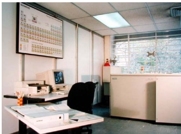
Figura 2.8. Espectrómetro secuencial de rayos X Siemens SRS 3000, Laboratorio de Fluorescencia de Rayos X, Instituto de Geología, UNAM.
