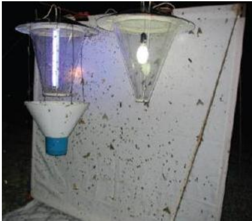
Figura 3. Trampa de atracción luminosa tipo Pennsylvania-Minnesota modificada por Zaragoza-Caballero para el proyecto LINBOS.
