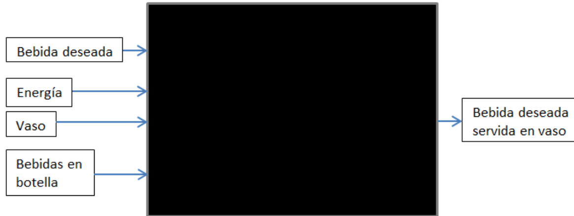
Figura 4.a.1. Entradas (derecha), proceso (centro) y salida (Izquierda).
