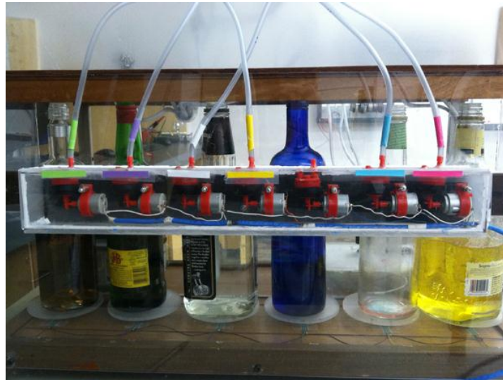
Figura 2.b.3. Mangueras y arreglo de bombas.
