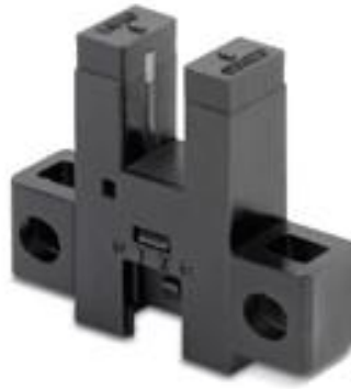
Figura 4.c.vii.5. Primera opción de SS3. Fototransistor H21A1 de herradura.
