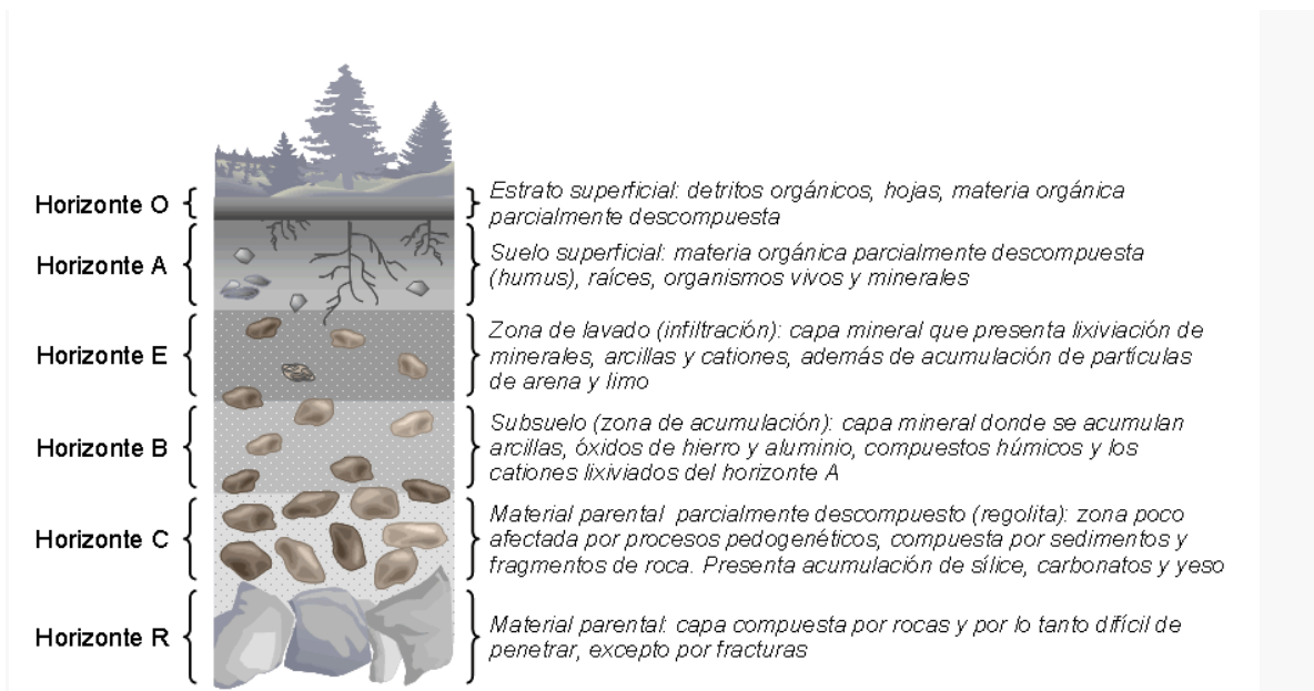
Figura 2.2 Perfil general de un suelo. Fuente. Crosara, 2009
