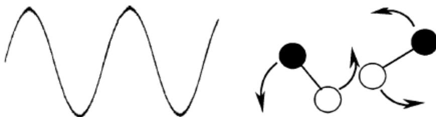
Figura 9. Moléculas dipolares alineándose con un campo eléctrico oscilante
