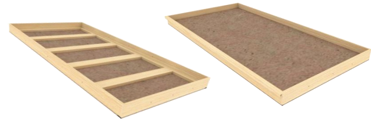
Fig. 21 BASTIDOR Y CAJÓN
