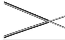
4. Sujeta los alambres con el alicate universal por la parte del aislante y con el alicate de punta procede a trenzar las puntas peladas hasta culminar.
