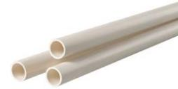
El tubo conduit rígido no metálico se fabrica con un material resistente a la humedad como el **Cloruro de Polivinilo (PVC)**, es auto extingible y resiste el ataque de agentes químicos corrosivos. Se puede doblar fácilmente al someterlo al calor. Para unir un tubo con otro no se requiere de un anillo de unión y pueden usarse conectores para tubos. Ampliamente usado en instalaciones eléctricas residenciales.
