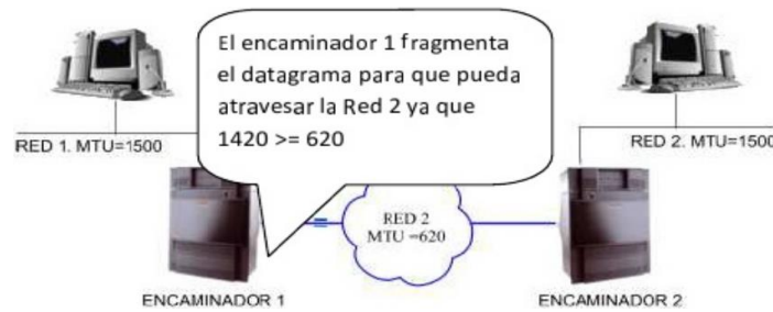
Figura 2.18 El siguiente paso que realiza el datagrama es que llega al router 1 y verifica su tamaño para que pueda atravesar la red 2 pero al ver que su MTU es de 620 bytes, entonces fragmenta el datagrama
