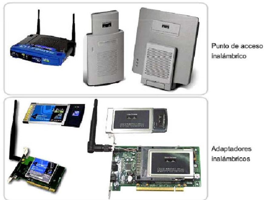
Figura 1.19 Adaptadores y puntos de acceso de una WLAN
