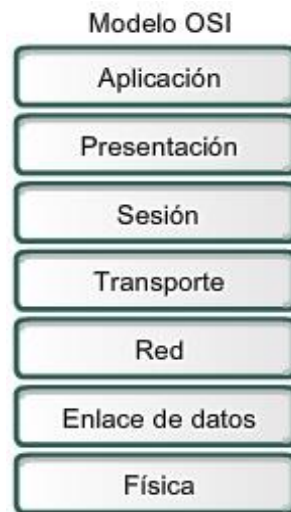
Figura 1.2 Modelo OSI conformado por 7 capas
