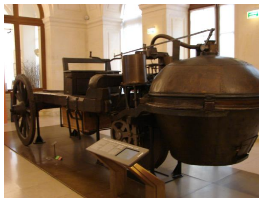
FIGURA 1.1 Fardier à vapeur (“Coche de vapor”) del año 1771. [2]
