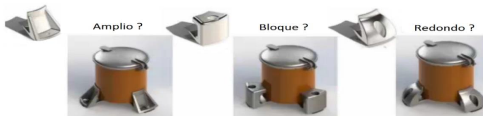
Figura 2.10 Posibles opciones a utilizar en una optimización topológica tradicional. [19]
