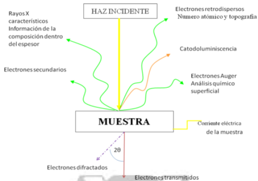
Figura 7. Interacción de los electrones con la muestra obtenidas mediante SEM.
