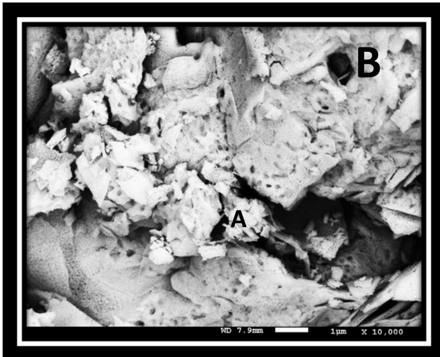
Figura 25. Micrografía correspondiente a las partículas de óxido de itrio obtenido mediante SEM con una amplificación de 10000x.
