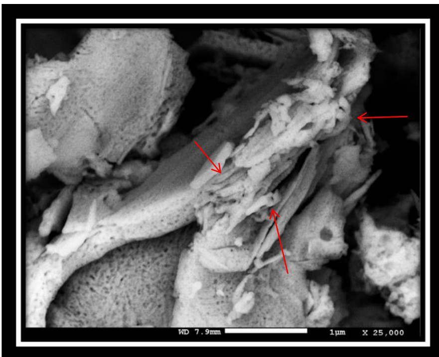
Figura 28. Micrografía correspondiente a las partículas de óxido de itrio obtenido mediante SEM con una amplificación de 25000x.
