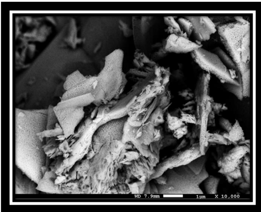
Figura 27. Micrografía correspondiente a las partículas de óxido de itrio obtenido mediante SEM con una amplificación de 10000x.
