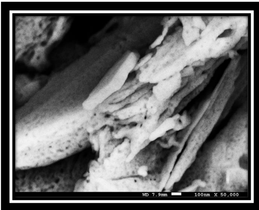
Figura 29. Micrografía correspondiente a las partículas de óxido de itrio obtenido mediante SEM con una amplificación de 50000x.
