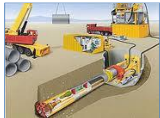
Figura III.2.1.5.1 Proceso para el método de Pipe Jacking (izquierda), Proceso de hincado de tubería (derecha)
