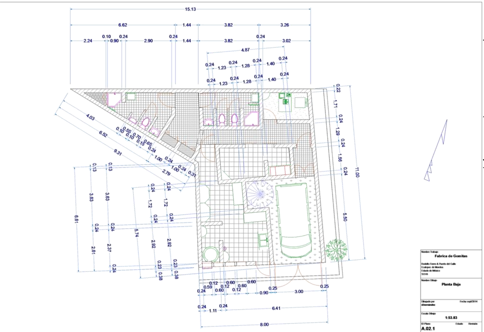
Figura 15. Croquis de la Fábrica (Planta Baja)
