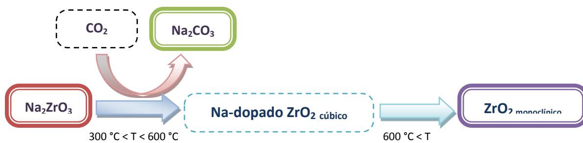
Figura 3.11. Representación de las fases generadas en la quimisorción de \text{CO}_2 en el \text{Na}_2\text{ZrO}_3 .
