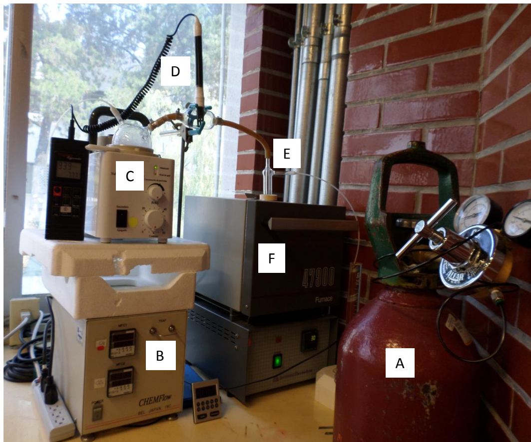
Figura 2.1. Sistema construido para determinar el efecto de la presencia de vapor de agua en el proceso de quimisorción de \text{CO}_2 en el \text{Na}_2\text{ZrO}_3 a temperaturas mayores a 100\text{ }^\circ\text{C} .
