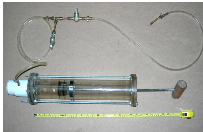
Figura 4.5 Sistema de inyección de aire
