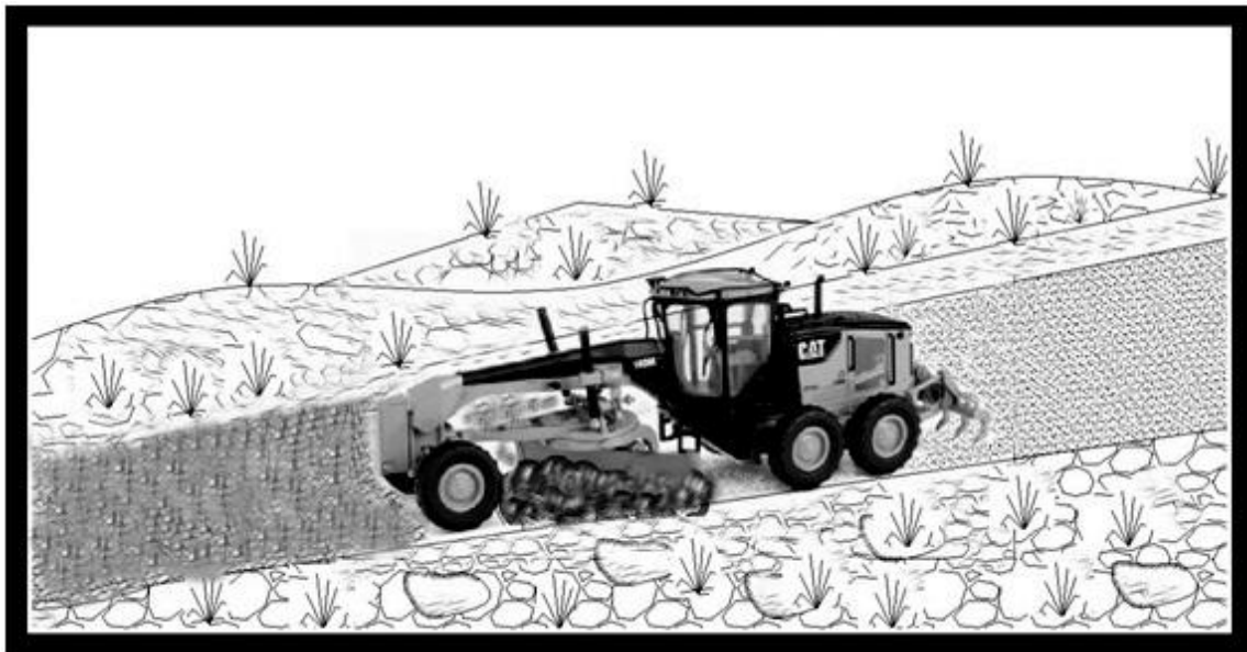
Fig. 27.-Extendido del material del terraplén por medio de motoconformadora.
