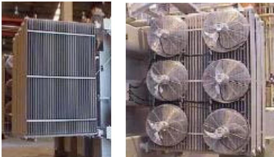
Figura 2.5. Tubos radiadores y ventiladores.
