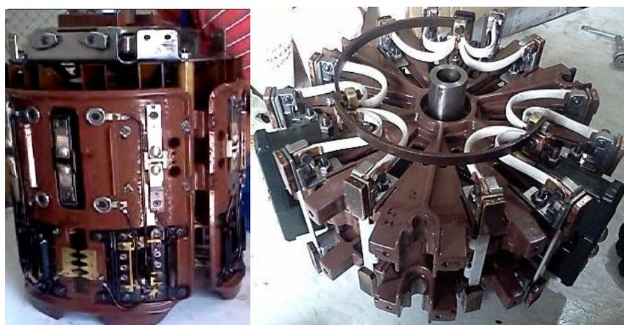
Figura 2.12. Selector de derivaciones.
