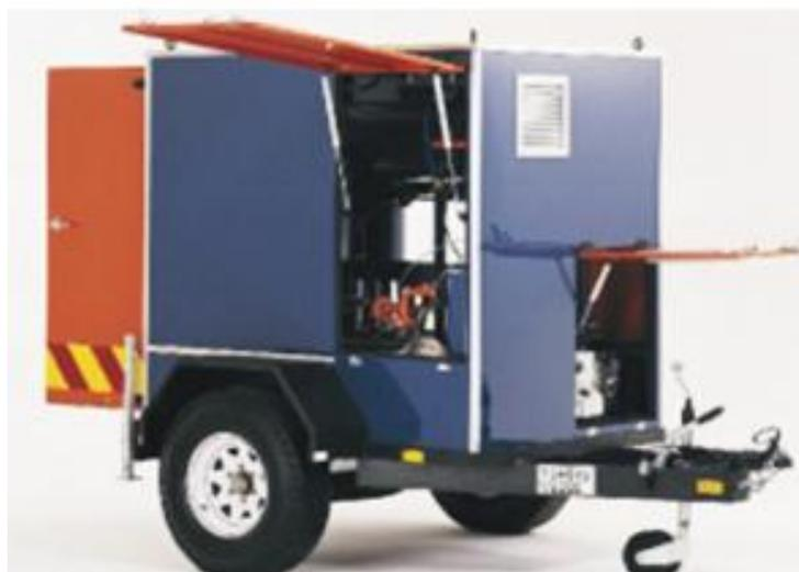
Figura 5.3. Purificadora (deshidratadora y desgasificadora).
