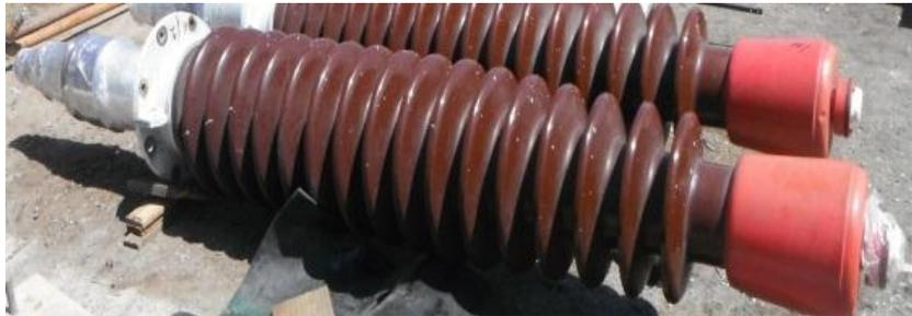
Figura 2.6. Boquillas de B.T.
