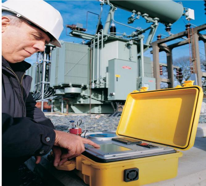
Figura 7.14. Análisis de la muestra de aceite con el equipo.
