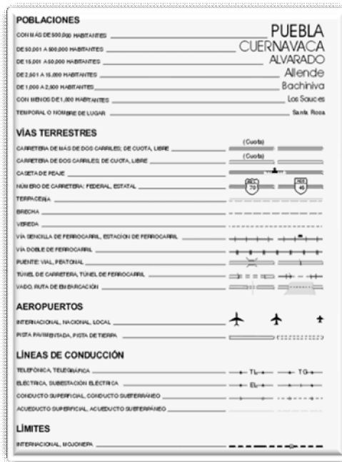
3.8 Parte de la simbología utilizada por el INEGI. FUENTE: Manual de actualización Cartográfica INEGI 2003.
