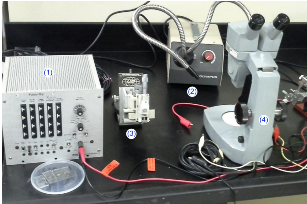
Figura 5.1. Sistema de estimulación celular (1) e iluminación del sustrato (2). Micro manipulador (3) y microscopio estereoscópico (4).
