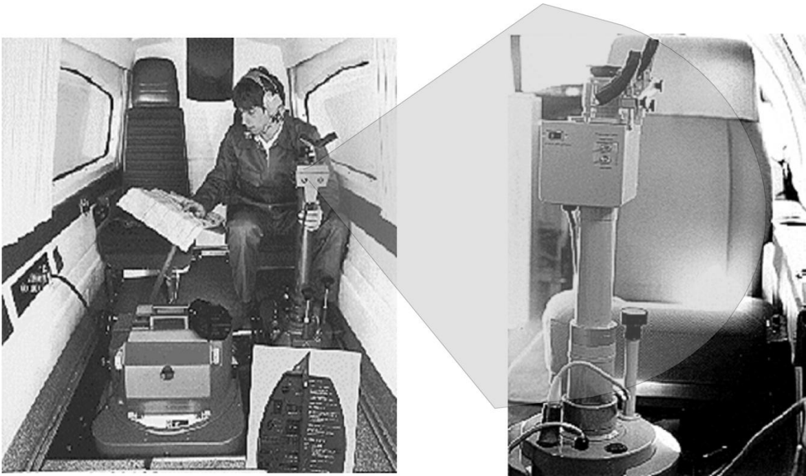
Figura 2.41. Accesorios complementarios, en ambas imágenes se observa una mira de navegación instalada en el avión.
