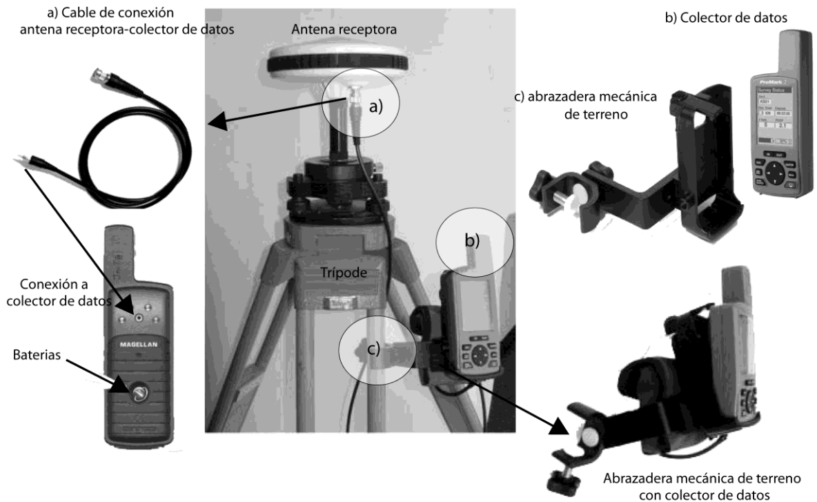
Figura 2.62. Componentes necesarios en la conexión y empotramiento del colector de datos. (Elaboración propia).
