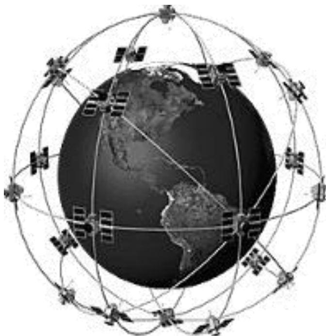
Figura 2.16. Esquema de la constelación NAVSTAR. (Fuente: Peter H. Dana, Departamento de Geografía, Universidad de Texas).
