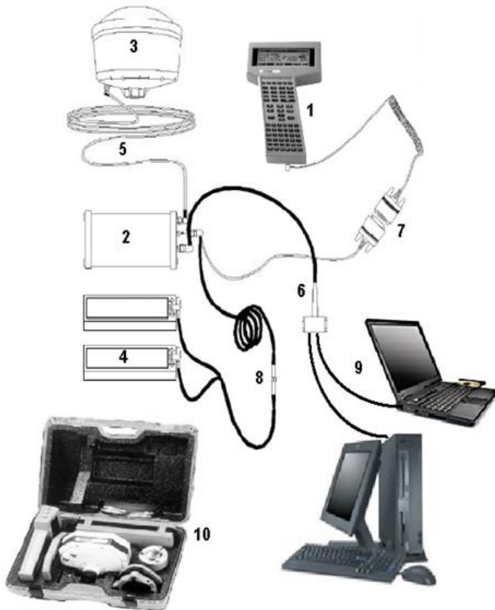
Figura 2.21. Elementos de un equipo receptor del GPS. (Segmento Usuario). (Fuente: Manual de Normas para la Actualización de la Cartografía, Vía Sistema de Posicionamiento Global (GPS). INEGI. México, Pág. 41).
