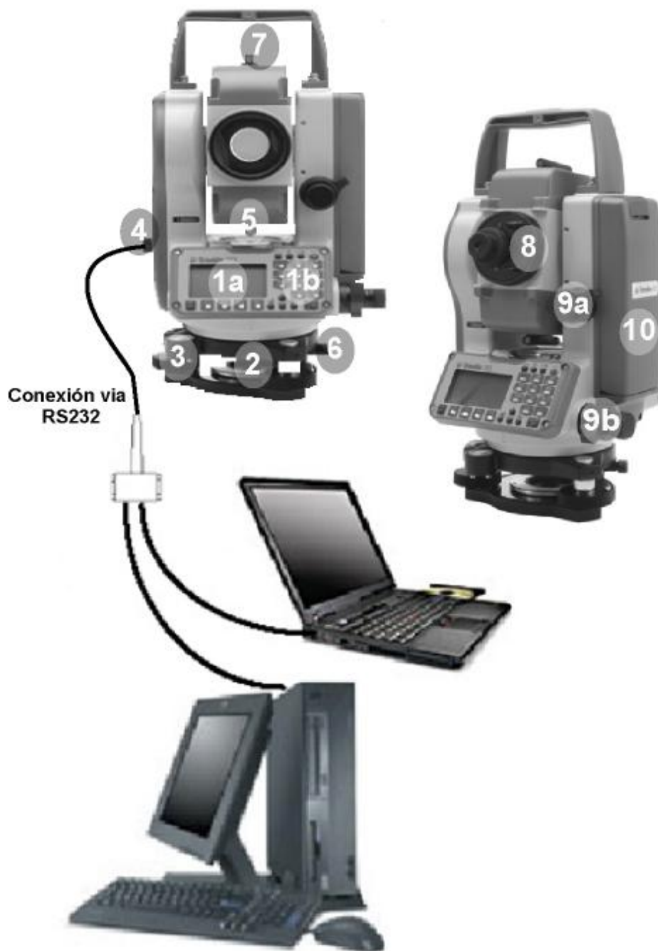
Figura 2.15. Partes fundamentales de una estación total. (Fuente: Imagen de fondo: www.trimble.com . Esquema funcional: Elaboración propia).
