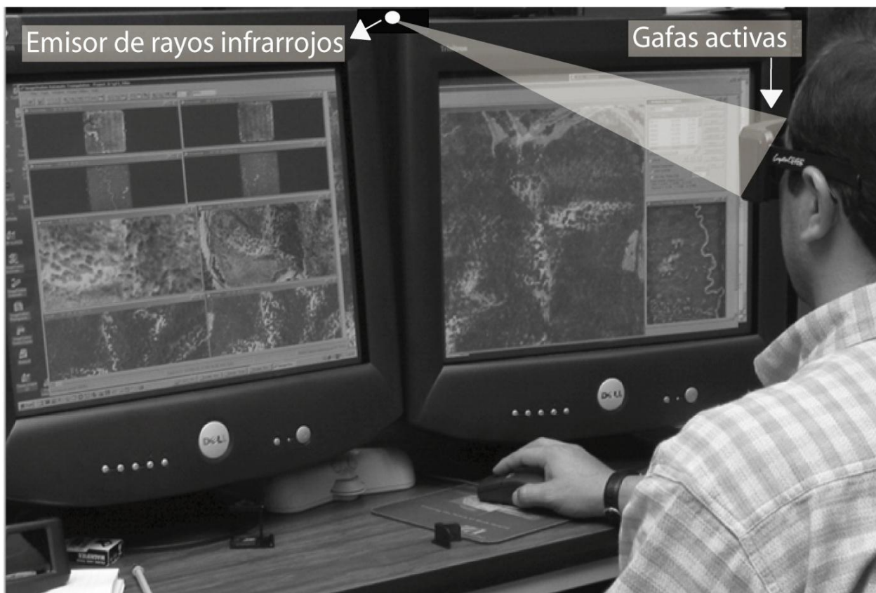
Figura 3.26. Sistema de visión estereoscópica con separación temporal y radiométrica con sistema emisor de rayos infrarrojos y gafas activas.
