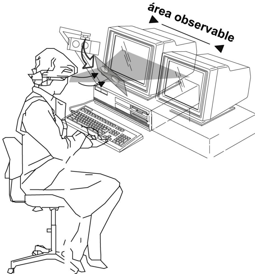
Figura 3.24. Sistema de visión estereoscópica con separación espacial. (Elaboración propia).
