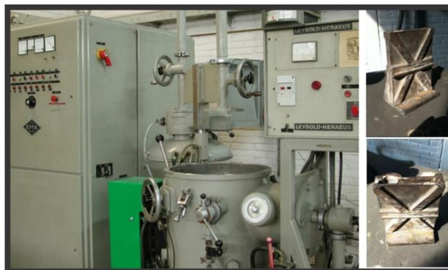
Figura 2.2 Horno de inducción y lingotera.
