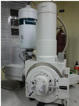
**Figura 2.14** Microscopio electrónico de barrido (SEM) laboratorio UDIATEM UNAM Fac. Ingeniería
