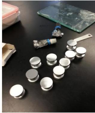
**Figura 7.38** Bases maquinadas en torno
