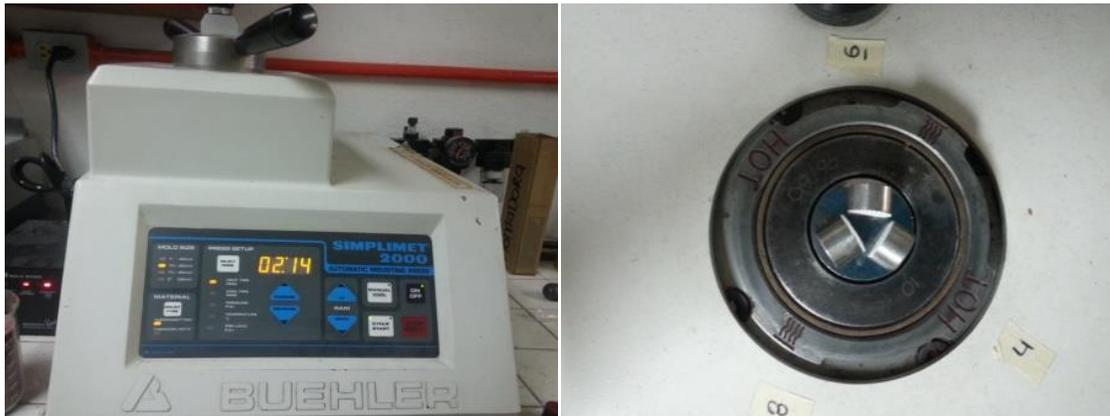
**Figura 7.22** a) Montadora de baquelita Buehler b) Acomodo de probetas para realizar el montaje
