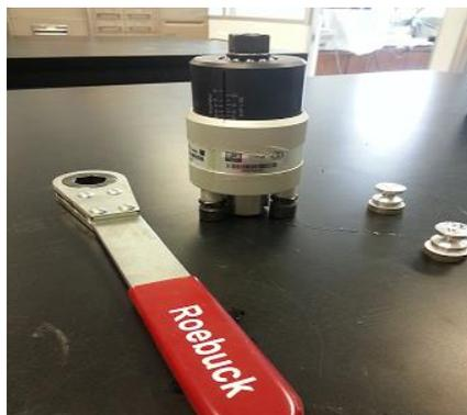
**Figura 7.8** Equipo para ensayo de adherencia
