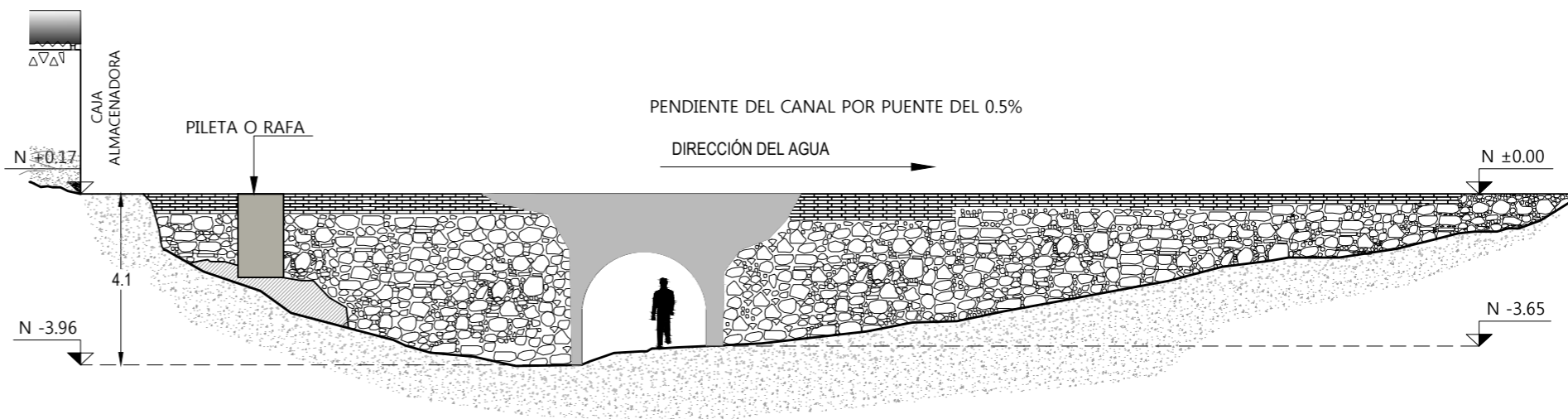
Alzado del puente. Escala 1:150.
