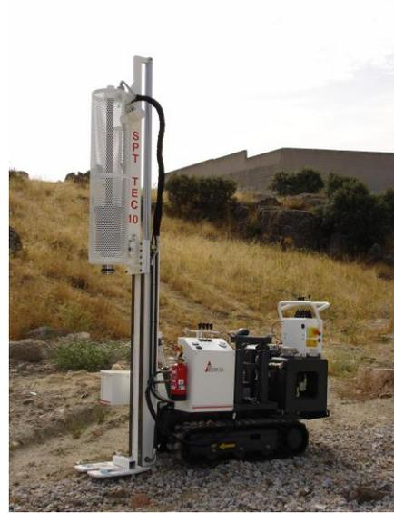
EQUIPO PARA STP O PRUEBA DE PENETRACION ESTANDAR.
