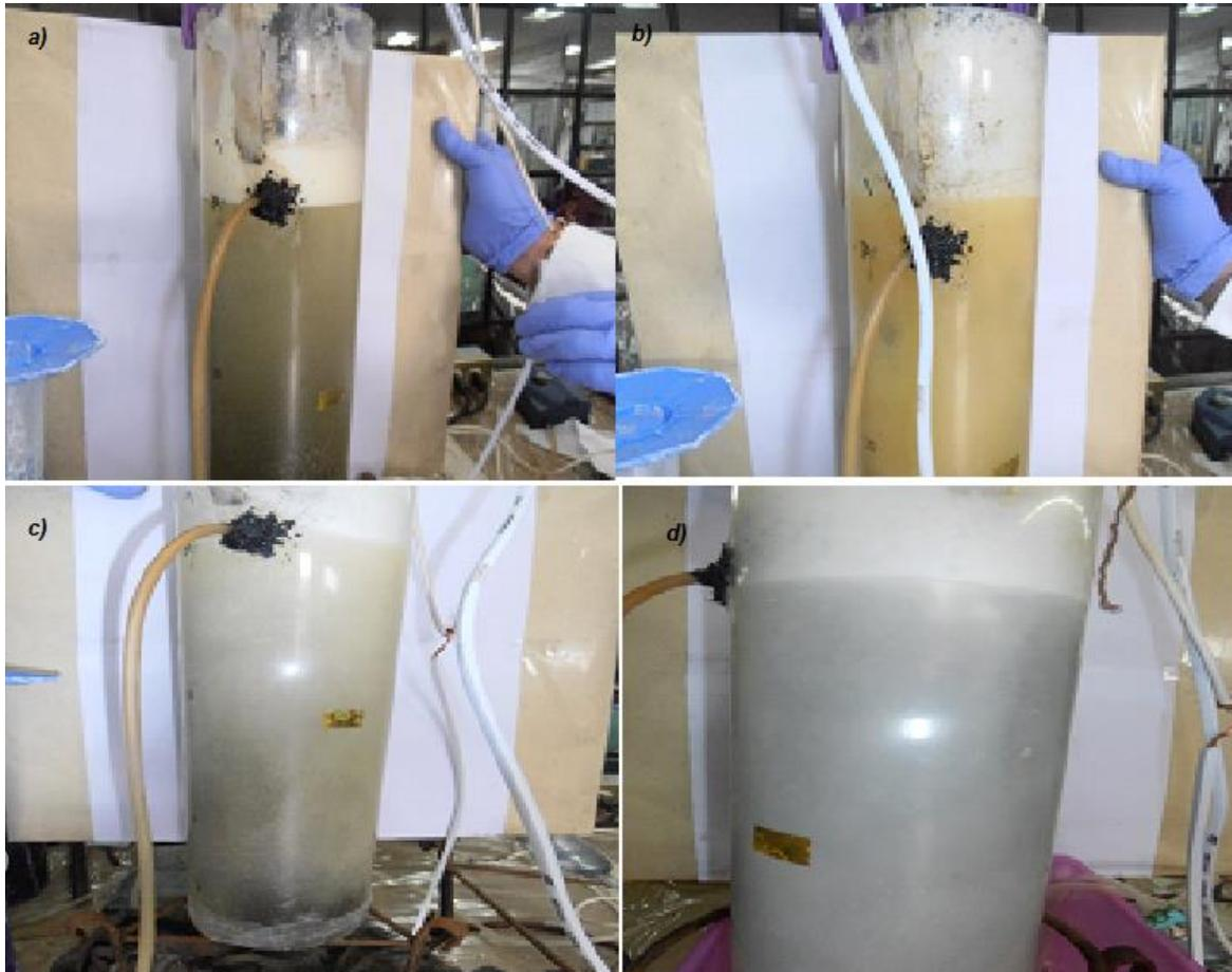
**Figura.20** Cambio de color del agua tratada a través del tiempo de fenol y 4-nitrofenol. a) De 500 mg/L a 90 mg/L, b) De 89 mg/L a 25, c) De 24 mg/L a 1 mg/L, d) 0 mg/L
