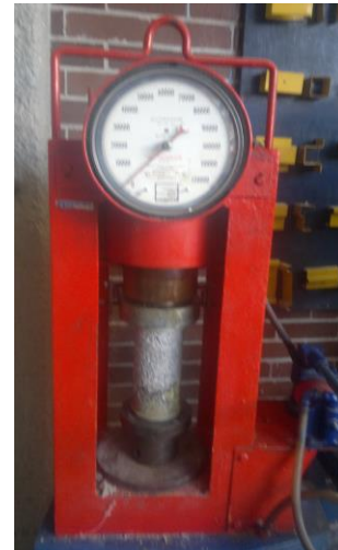
Fotografía 46 (muestra resultado a 28 días de 1400kg)
