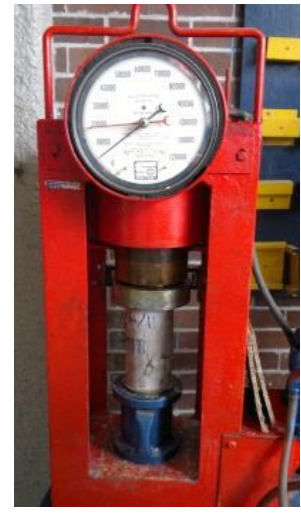
Fotografía 31 (muestra resultado a 14 días de 82000kg)
