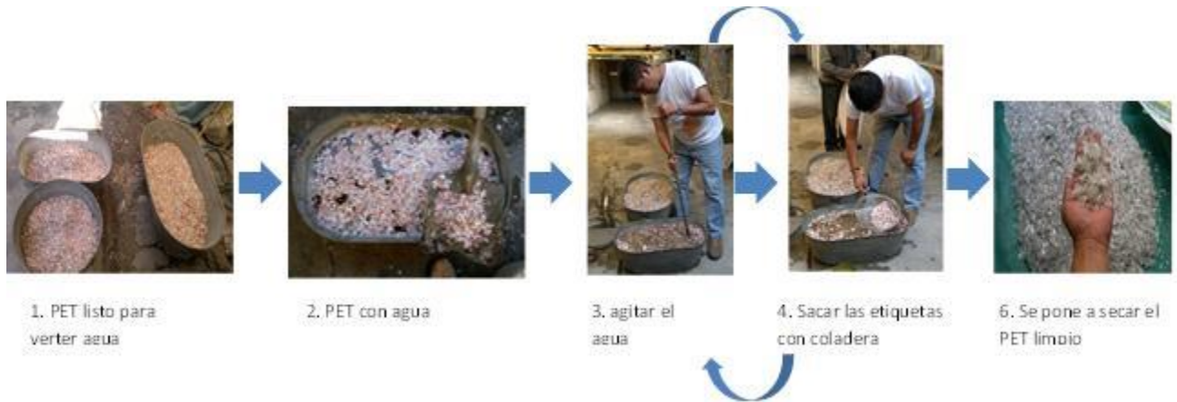
Figura 2 (muestra el procedimiento de lavado de PET triturado)
