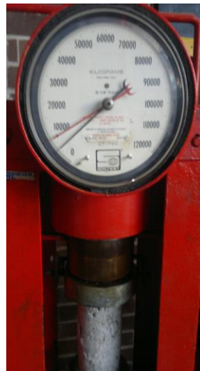
Fotografía 56 (muestra resultado a 28 días de 83000kg)
