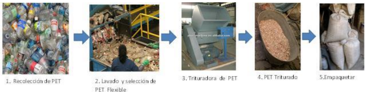
Figura 1 (proceso de lavado y selección de PET)
