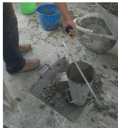
Fotografía 68 al tocar cualquier mezcla que se le agregó PET baja el revenimiento a 12 a 10
