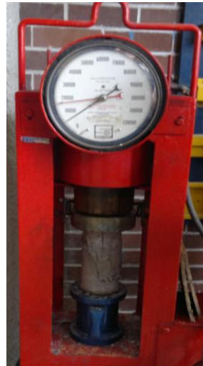
Fotografía 30 (muestra resultado a 14 días de 16400kg)
