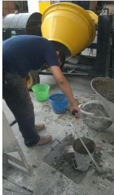
Fotografía 23 (Muestra la realización de la prueba de revenimiento de 7.5 cm )
