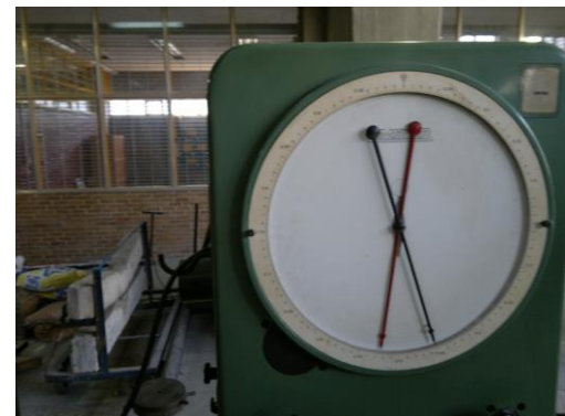
Fotografía 59 (muestra resultado a la tensión a 28 días de 52500kg)
