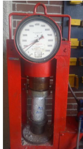
Fotografía 53 (muestra resultado a 14 días de 72000kg)
