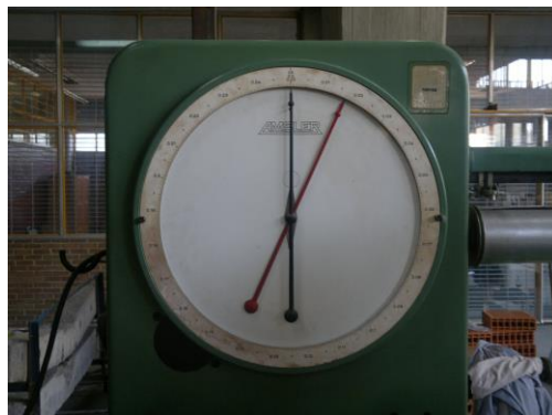
Fotografía 63 (muestra resultado a la flexión a 28 días de 1700kg)
