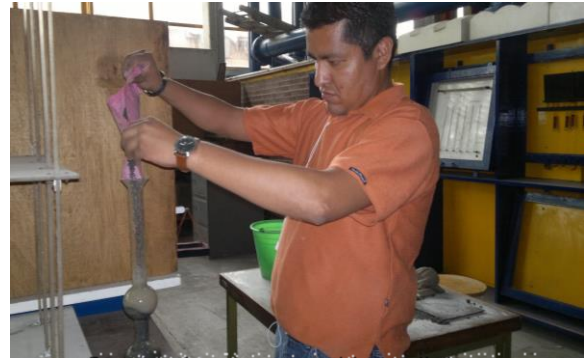
Fotografía 8 (muestra parte del procedimiento para determinar la densidad de la arena)
