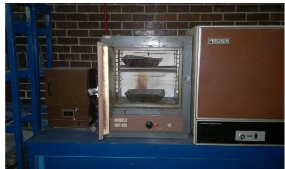
Fotografía 17 (muestra la colocación de la grava en el horno para determinar su porcentaje de absorción)
