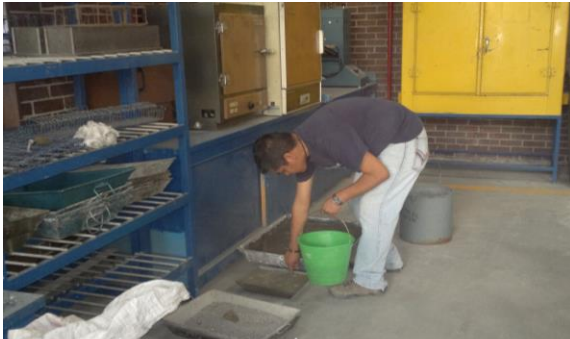
Fotografía 5 (muestra la saturación de la arena para posteriormente determinar el contenido de absorción y densidad)
