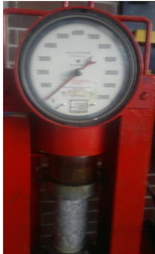
Fotografía 45 (muestra resultado a 28 días de 1900kg)
