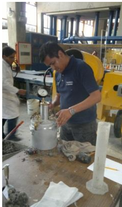
Fotografía 25 (Muestra la realización del la prueba contenido de aire al concreto)
