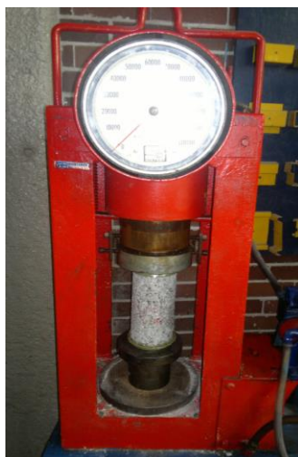
Fotografía 43 (muestra resultado a 14 días de 1800kg)
