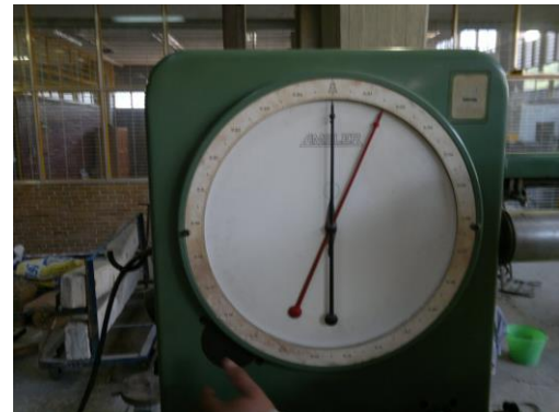
Fotografía 57 (muestra resultado a la flexión a 28 días de 16000kg)
