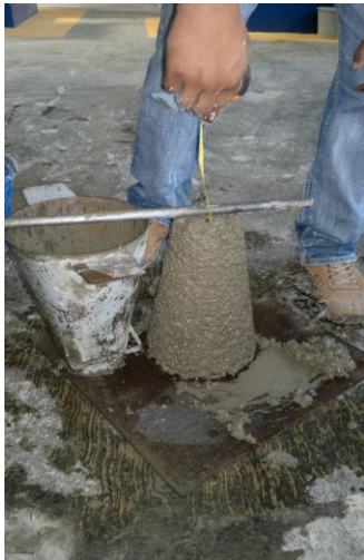
Fotografía 40 (muestra el revenimiento de 1 cm obtenido)
