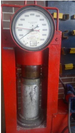
Fotografía 60 (muestra resultado a la compresión a 7 días de 2350kg)
