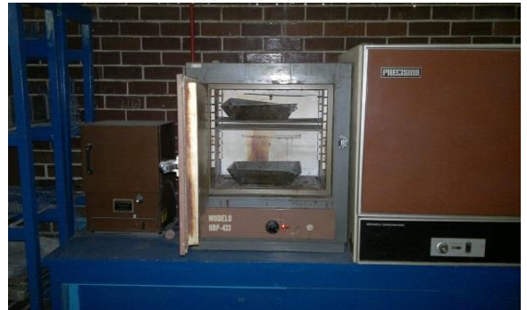
Fotografía 10 (muestra el horno con la arena para determinar su grado de absorción después de haberse pesado en estado SSS y seco)
