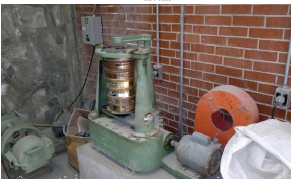
Fotografía 11 (muestra cuando se coloca en las mallas para determinar el módulo de finura)
