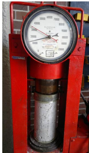
Fotografía 61 (muestra resultado a la compresión a 28 días de 32300kg)
