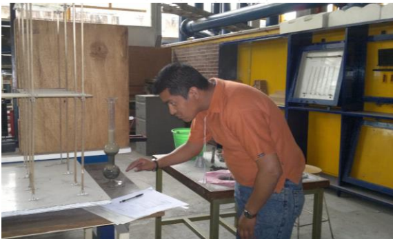
Fotografía 9 (muestra cómo se determinó la densidad de la arena)
