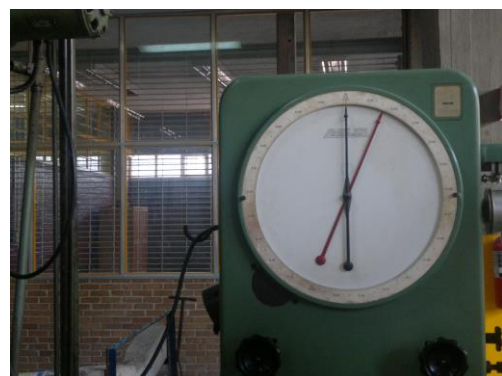
Fotografía 64 (muestra resultado a la flexión a 28 días de 1640kg)
