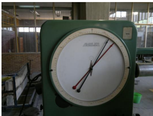
Fotografía 49 (muestra resultado a la tensión a los 28 días de 1170kg)
