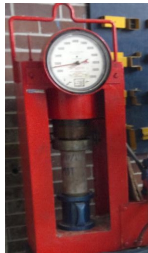
Fotografía 33 (muestra resultado a 28 días de 17600kg)
