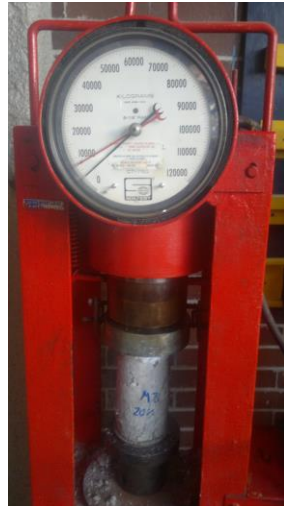
Fotografía 52 (muestra resultado a 7 días de 71000kg)
