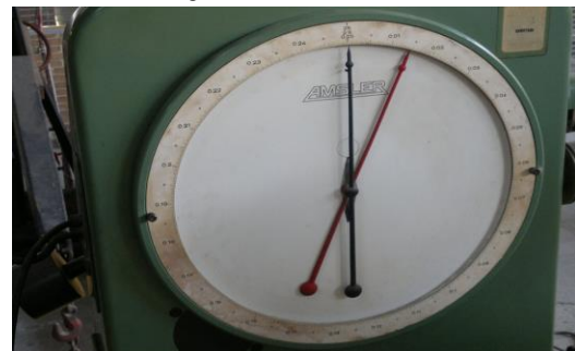
Fotografía 34 (muestra resultado a 28 días de la flexión 1500kg)
