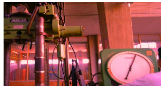
Fotografía 37 (Muestra los resultados a la tensión a 28 días 8350 kg)
