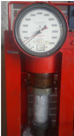
Fotografía 55 (muestra resultado a 28 días de 60000kg)
