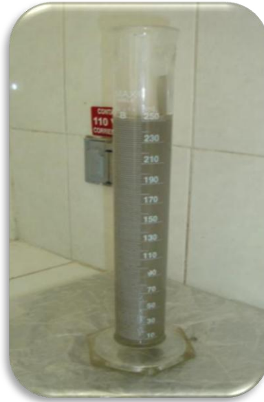
Figura 2.8. Probeta para prueba de agua libre.
